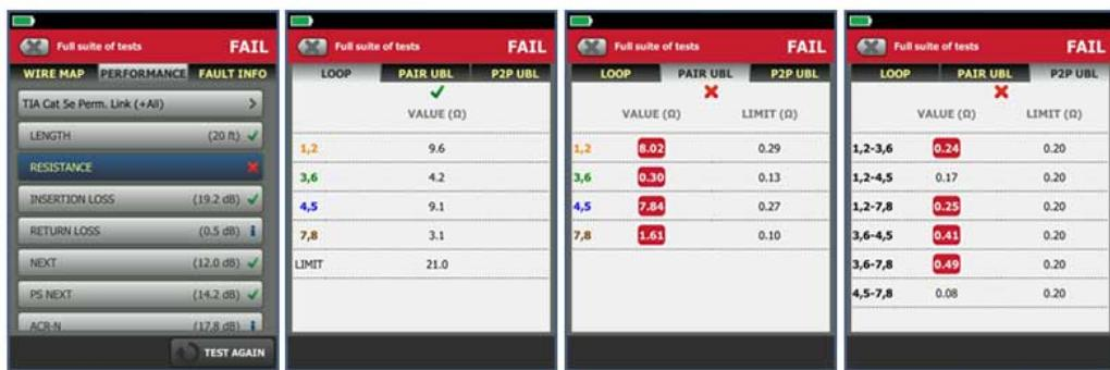
ANSI/TIA 1152 현장 테스트 표준은 이제 현장 테스트에 DC 저항 불균형을 포함합니다. 한계는 ANSI/TIA -568-C.2에 포함되어 있습니다. 그것은 필수 인증 요구 사항은 아니지만, DSX-CableAnalyzer와 같은 우수한 케이블 테스터를 가지고 있는 경우 보통 포함되어 있습니다. 그러나 한가지 문제가 있습니다. ISO/IEC 11801 ed. 2.2가(이) 채널 및 영구 링크 정의에 대한 DC 저항 불균형 테스트 한계를 제공하는 한편, ANSI/TIA-568-C.2는 채널 정의에 대한 테스트 한계만을 제공합니다.
