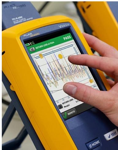
**2. Precision fiber channel information:** With the increasing use of short patch fibers and multi-fiber connectors, details on every link—loss, connector, and reflectance—are critical to ensuring performance. 3m 이상의 감쇠 데드 존이 있는 OTDR은 데이터 센터 광케이블 테스트에 더 이상 적용되지 않습니다. 링크 손실 예산을 위태롭게 하거나 심각한 신호 저하가 발생하는 문제를 찾기 위해 극단적으로 짧은 데드 존이 필요합니다. 또한 빠른 문제 해결을 위해서는 다양한 기술 수준의 사용자가 광케이블 문제 해결을 효율적으로 수행하고 네트워크 복구를 가속화할 수 있도록 오류 및 이벤트를 간단한 그래픽 맵으로 표시해야 합니다.
