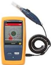
FI-7000 FiberInspector Pro는 광케이블 검사 스코프로서, 1초 내에 광케이블 커넥터의 종단면을 검사하고 인증할 수 있으며 작업을 처음 시도에서 완료할 수 있게 해줍니다. 광선로 검사 범위는 자동화된 통과/실패 인증을 제공하여 누구나 광케이블 전문가가 될 수 있도록 광케이블 인증에서 추적을 배제합니다. FI-7000은 오염, 파임, 꺾임 및 굽힘으로 인한 문제 영역을 그래픽으로 표시해줍니다. 이제 광케이블 케이블을 업계 표준 IEC 61300-3-35에 따라 쉽게 인증할 수 있으며, 인증 과정 중 광케이블 커넥터 종단면 보기를 저장함으로써 종단면 측정에서 인적 주관성을 제거합니다.
