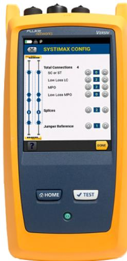
그림 3. CommScope SYSTIMAX 링크 손실 계산기는 Fluke Networks CertiFiber Pro 광학 손실 테스트 세트의 최신 버전에 내장되어 있습니다. CertiFiber Pro 소유자는 Fluke Networks 웹사이트에서 무료로 다운로드해서 계산기를 테스터에 추가할 수 있습니다.
