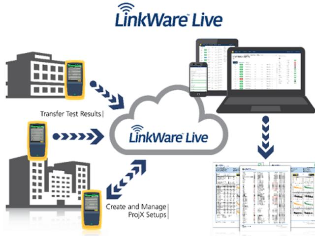
그림 4. 프로젝트 매니저는 LinkWare Live를 사용하여 테스트 설정을 만들고 관리하며 테스트에 전송할 수 있습니다. 기술자는 테스트 결과를 업로드하여 프로젝트 매니저가 작업 진행 상황을 추적할 수 있도록 합니다.
