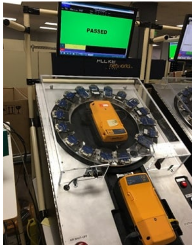
그림 1 - 구리 캘리브레이션 기지. 열일곱 개의 사용자 정의 설계된 아티팩트가 캘리브레이션을 위해서 Versiv 장치에 차례차례로 연결되어 있습니다. 자동 훔 설정은 생산 물량을 다루기 위해 공장에서만 사용됩니다.
