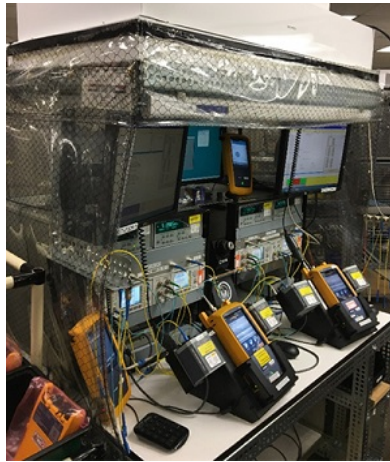
그림 2 - 광케이블 캘리브레이션 기지. 먼지를 줄이기 위해서 기지 주변 여과 시스템 상부에 설치된 비닐을 주목하십시오. Fluke Networks는 일부 시판되고 있는 제품을 개조해서 정확도 요구사항을 충족시킵니다.
